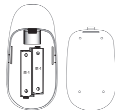
開け方 : 裏のカバーを下にスライド 単 4 乾電池 2 本 (※電池は別途)
